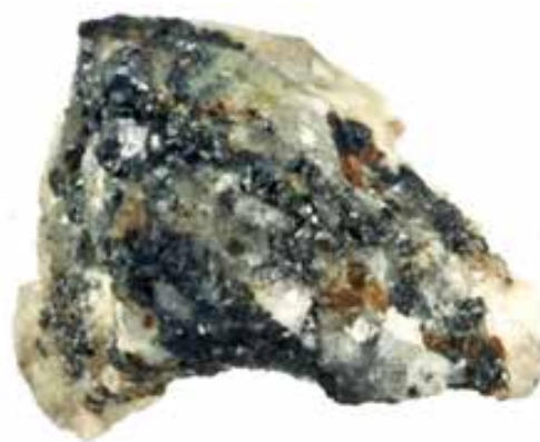
Fig. 12 - Campione di roccia contenente il quasicristallo naturale (icosaedrite Al 63 Cu-24Fe 13 ) scoperto da Luca Bindi
